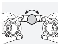
Genom att vrida fokuseringssringen kan du ställain skärpan på föremål på mycket nära håll (se tekniska data) och upp till oändligt.
