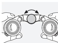
En faisant tourner la molette de focalisation, vous pouvez faire la mise au point sur chaque objet, de la distance minimum de mise au point (voir la fiche signalétique technique) à l'infini.
