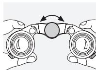
Durch Drehen des Fokussierrades können Sie jedes Objekt von der kürzesten Einstellentfernung (siehe Technisches Datenblatt) bis unendlich scharf stellen.
