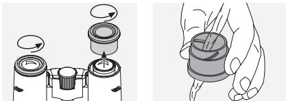
Bij sterke verontreiniging (bijv. zand) kan de oogklep er compleet afgeschroefd worden zodat het oculair eenvoudig kan worden schoongemaakt.
